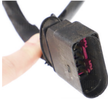
Wtyczka elektryczna bez uszkodzeń
