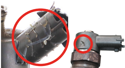
Poškozený konektor – škrábance
