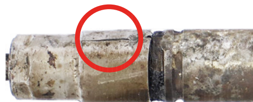
Těžce poškozené / prasklé tělo
